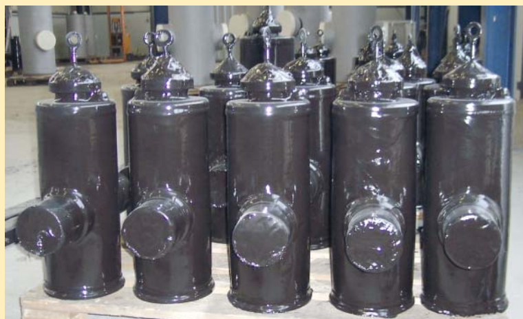
Bild 2. Schieber im Korrosionsschutzzentrum.
